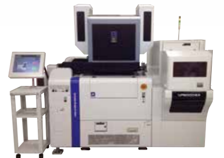
撮像素子テスター・プローバー 撮像素子をウェハ段階でプロービングし、 遮光/光照射状態で機能テストを行う
