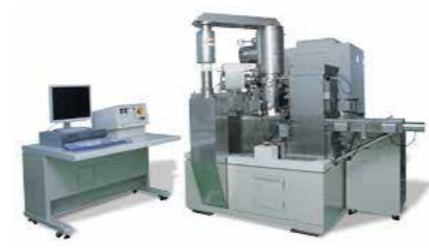
電子線描画装置 波面制御光源の製作のため、ナノメートルオーダーのパターンを形成
