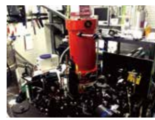
遠赤外・THz 波長域用検出器 高精度 THz 分光測定装置の開発に使用
